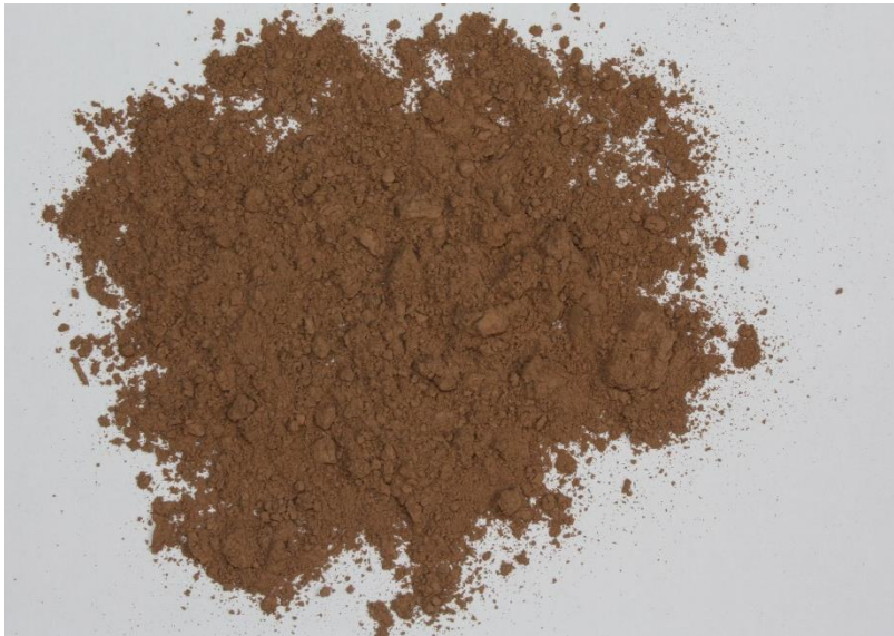
Bild 4 Calcinierte Probe „Mischprobe Schiefer-ton schwarz_800“ nach der Aufbereitung.
