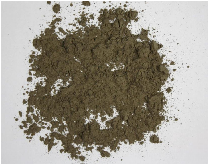
Bild 1 Probe „Mischprobe Schiefer-ton schwarz“ nach der Aufbereitung
